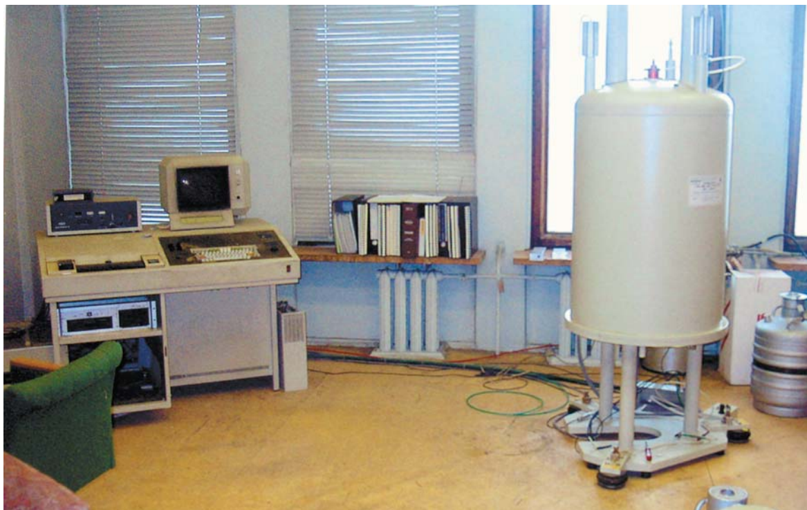
Рис.5. ЯМР-спектрометр высокого разрешения фирмы «Bruker», использующийся для выполнения многих типов квантовых операций на ансамблях органических молекул.
